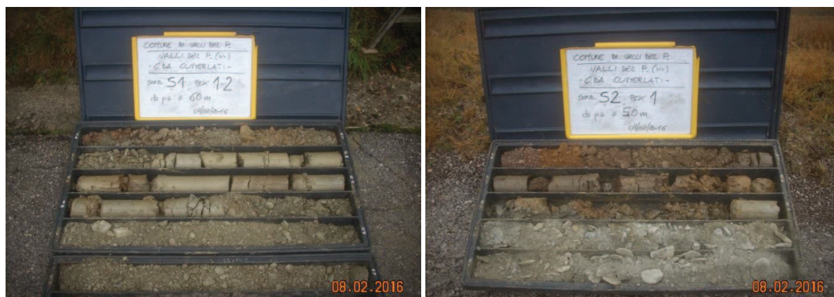
Figura 7 - Cassette catalogatrici rispettivamente del Sondaggio Geognostico S1 (da p.c. a – 6.0 m da p.c.) e del Sondaggio Geognostico S2 (da p.c. a – 5.0 m dal p.c.)
